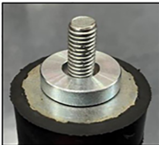
FIGUR 8. PLANBRICKA MONTERAD LÄNGST UPP PÅ EN VIBRATIONSDÄMPANDE INFÄSTNING
