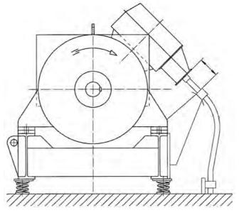
FIGURE 11. VIBRATION DAMPERS ON FOUNDATION. ENSURE FREE CABLE LENGTH.
