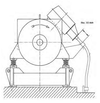
FIGURE 10. VIBRATION DAMPERS ON BASE FRAME. ENSURE FREE CABLE LENGTH.
