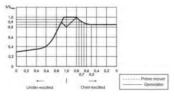
FIGURE 14. DEPENDENCY OF THE OUTPUT POWER ON THE POWER FACTOR
