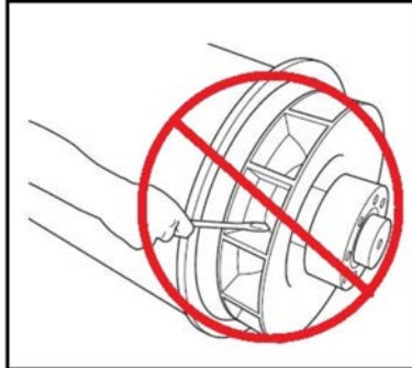
رسم توضيحي 8. لا تقم بتدوير العضو الدوار لمولد التيار المتردد بواسطة رافعة
