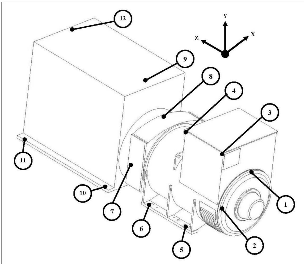
FIGURA 14. POSIÇÕES DE MEDIÇÃO DE VIBRAÇÃO
