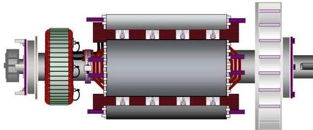
FIGURA 18. ROTOR DE ALTERNADOR DE DOIS ROLAMENTOS COM ILUSTRAÇÃO DO VEIO COM ESCATEL PARA ACOPLAMENTO FLEXÍVEL (À DIREITA)
