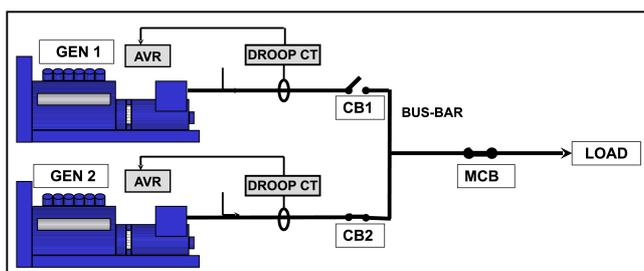
FIGURA 20. COLOCAÇÃO EM PARALELO OU SINCRONIZAÇÃO DE ALTERNADORES
