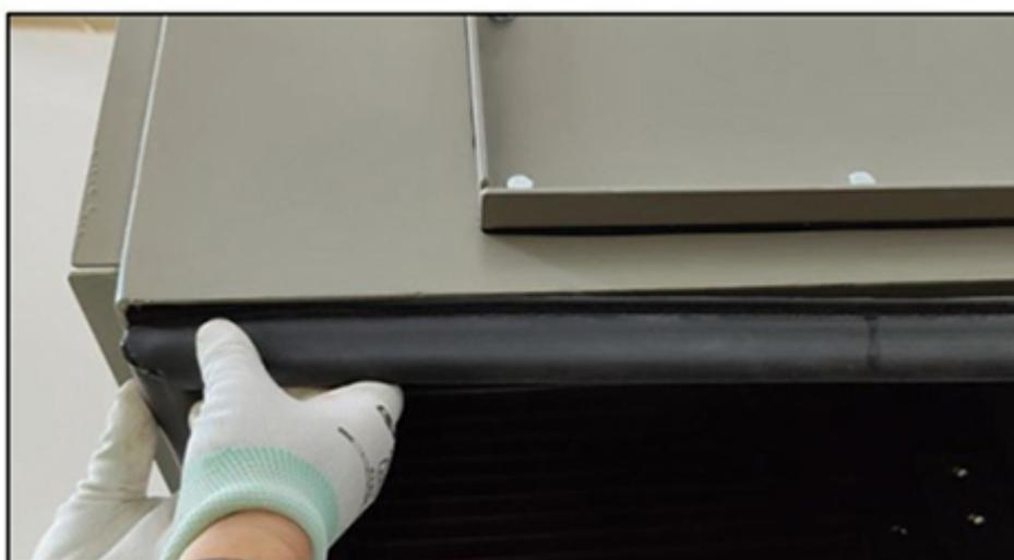
**FIGURA 9. JUNTA MONTADA**
