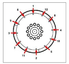
FIGURE 24. FIXING SEQUENCE
