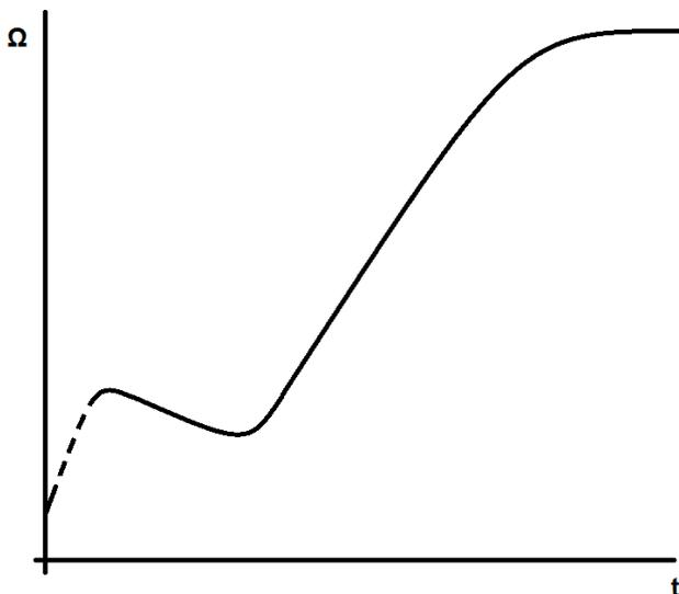
На типовом графике показано первоначальное повышение сопротивления, падение и затем постепенный рост до устойчивого состояния; при незначительном увлажнении обмоток часть графика, представленная пунктирной линией, может отсутствовать. По достижении устойчивого состояния продолжайте сушку в течение еще одного часа.
