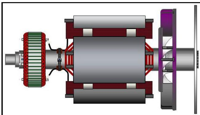
РИС. 5. НА РИСУНКЕ ПОКАЗАН РОТОР ГЕНЕРАТОРА С ОДНИМ ПОДШИПНИКОМ С ДИСКАМИ МУФТЫ, ПРИКРЕПЛЕННЫМИ БОЛТАМИ К СОЕДИНИТЕЛЬНОЙ МУФТЕ СО СТОРОНЫ ПРИВОДА (СПРАВА)
