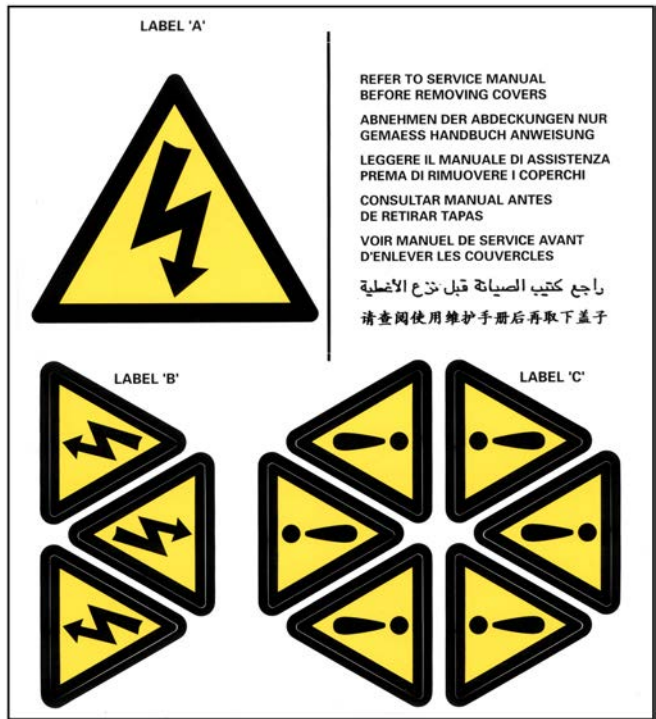
FIGURA 2. ETIQUETAS DE ADVERTENCIA DE PELIGRO
