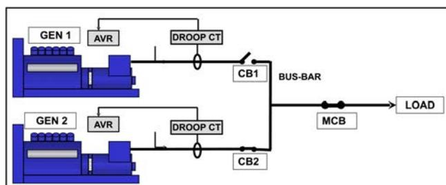
FIGURA 17. ALTERNADORES PARALELOS O DE SINCRONIZACIÓN
