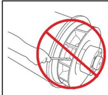
**FIGURA 12. NO ROTE EL ROTOR DEL ALTERNADOR CON UNA PALANCA**
