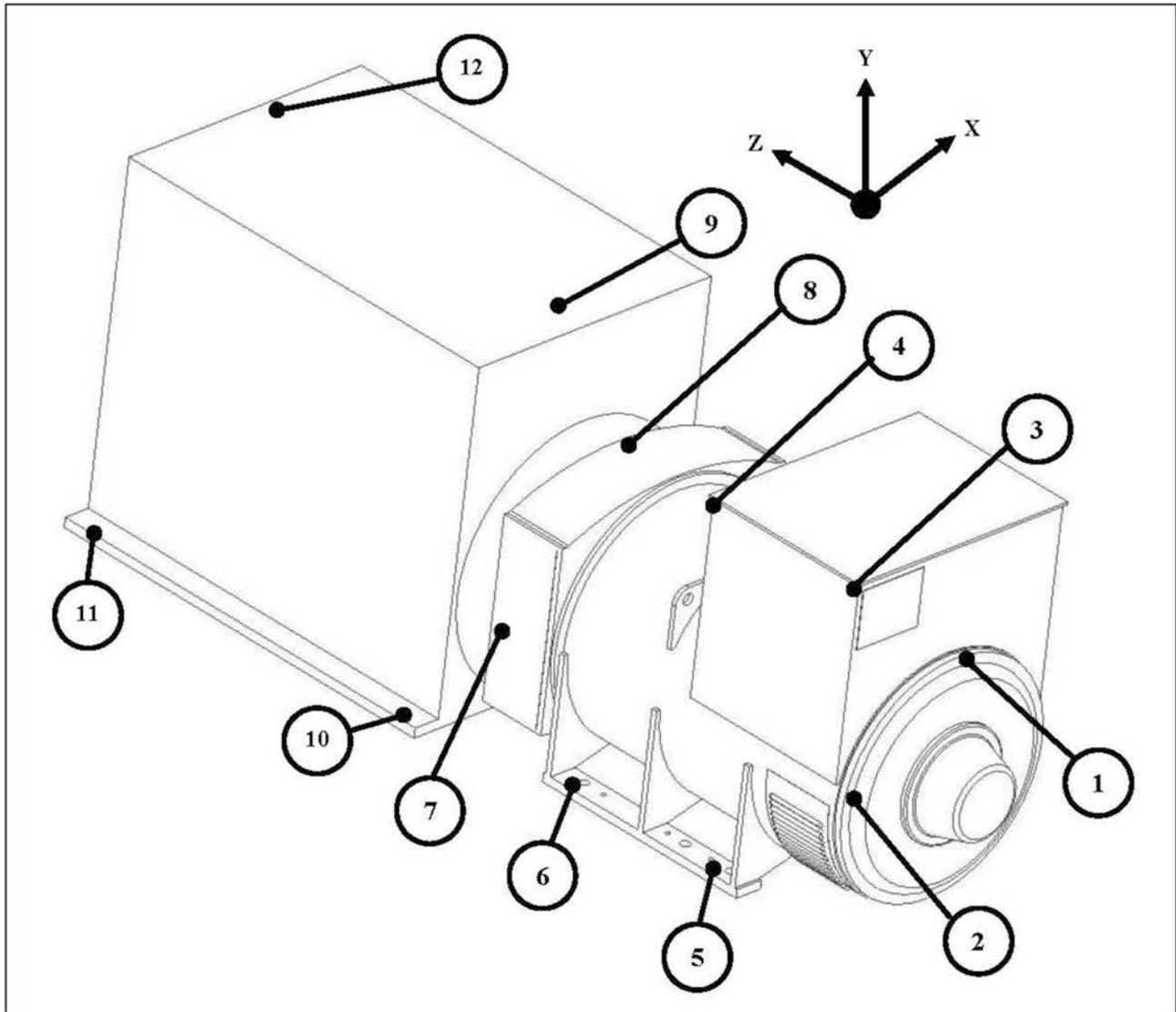
FIGURA 10. UBICACIONES DE MEDICIÓN DE LA VIBRACIÓN
