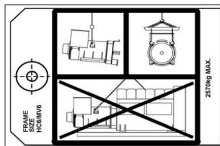
FIGURA 11. ETIQUETA DE ELEVACIÓN
