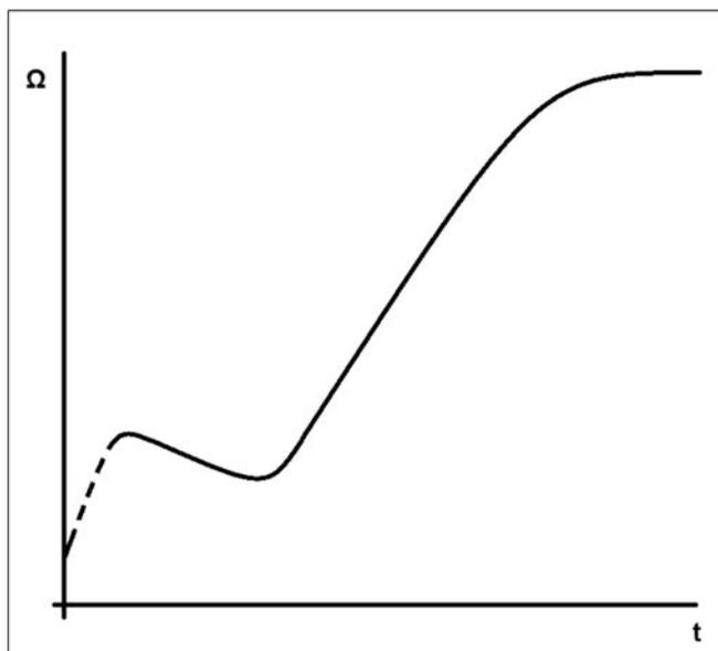
**FIGURA 19. GRÁFICO DE LA RESISTENCIA DEL AISLAMIENTO**
