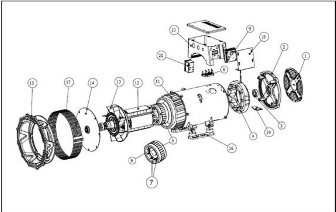
图 16. S0/S1 单轴承交流发电机
