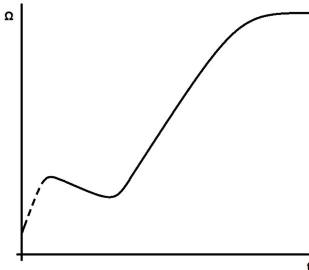
图 15. 绝缘电阻图
