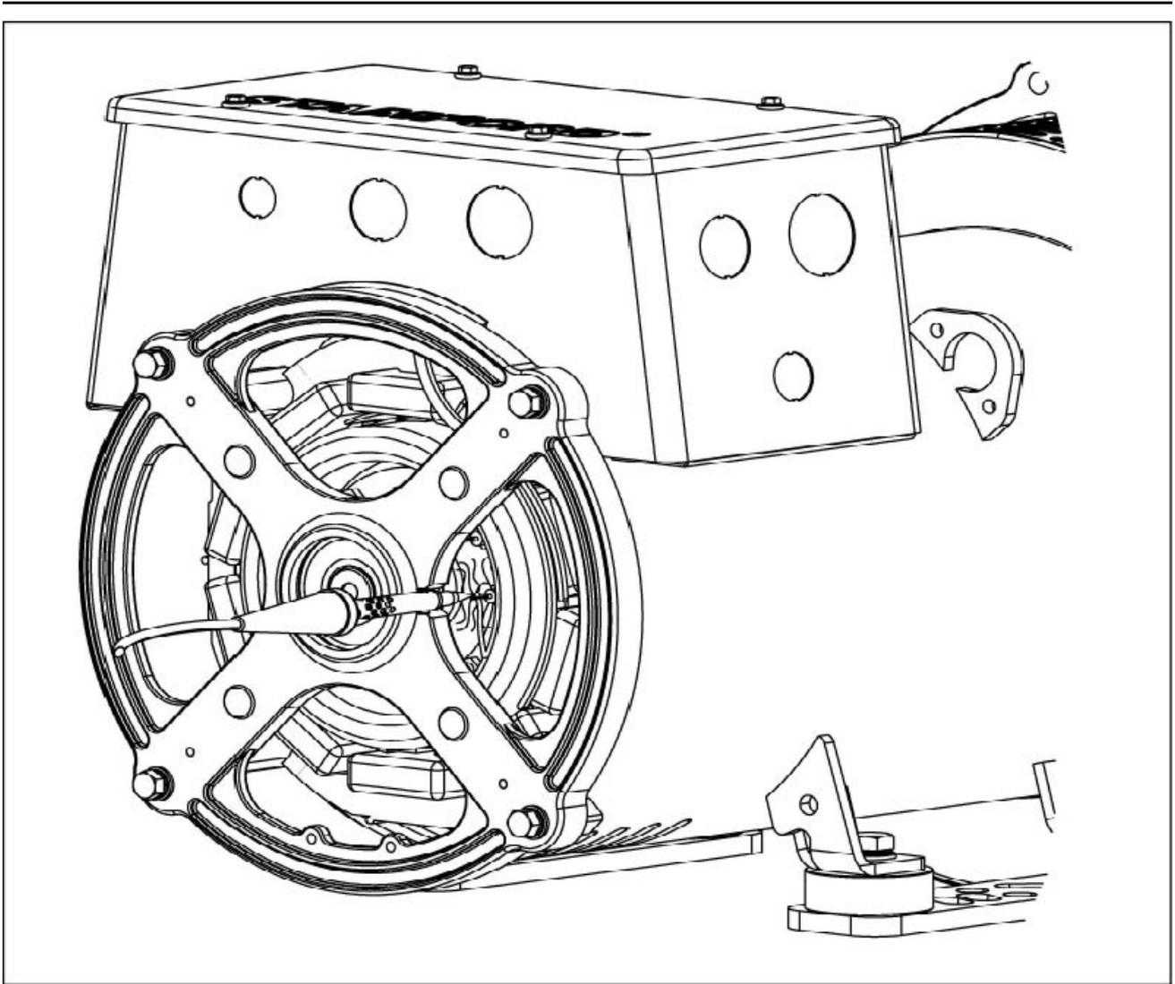
图 14. 拆卸二极管焊料
