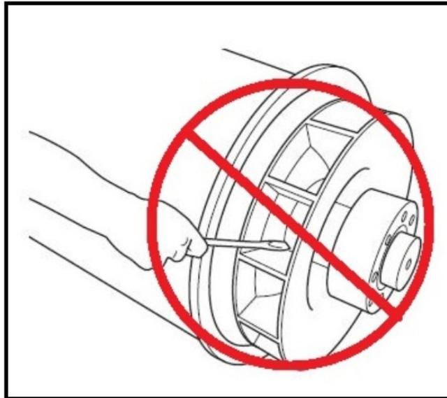
图 13. 请勿使用杆转动交流发电机转子
