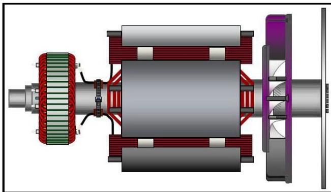
图 9. 显示用螺栓固定耦合盘到驱动端联轴器（右侧）的单轴承交流发电机转子
