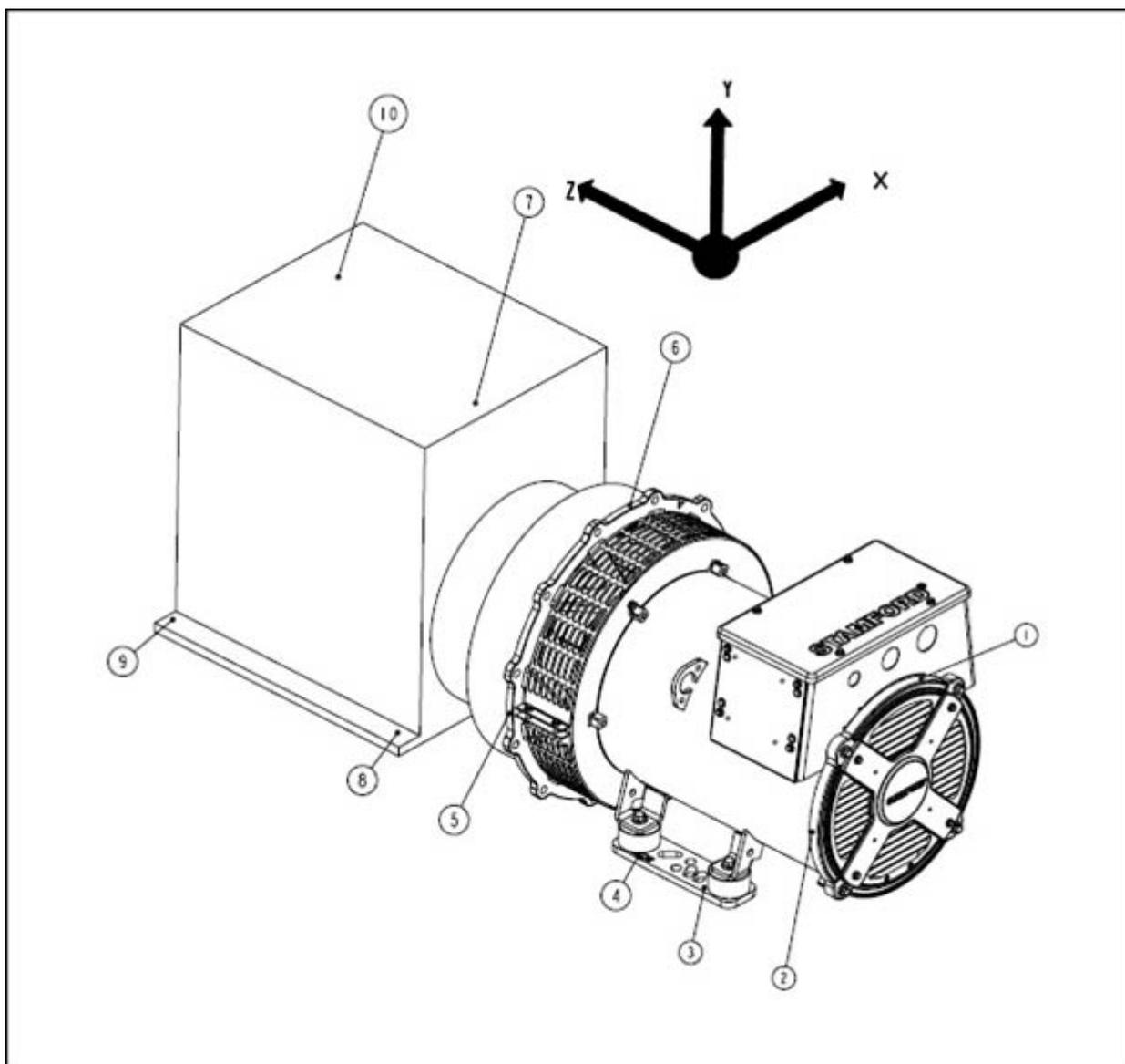
图 6. 振动测量位置
