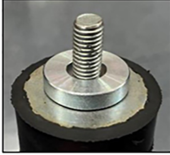
الشكل 6. فلكة مسطحة مثبتة على قمة جبل مضاد للاهتزاز
