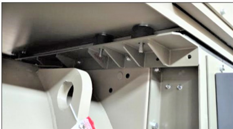
图 10. 将水冷却器降低到正确位置
