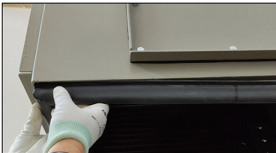
图 9. 安装后的垫片
