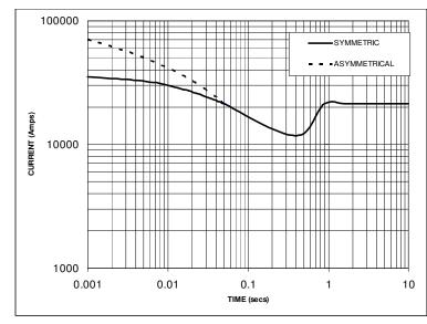
THE FOLLOWING MULTIPLICATION FACTORS SHOULD BE USED TO ADJUST THE VALUES FROM CURVES BETWEEN THE 0.001 SECONDS AND THE MINIMUM CURRENT POINT IN RESPECT OF NOMINAL OPERATING VOLTAGE
