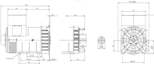
COUPLING DISC SAE 14 SAE 18 SAE 21 SAE 24
