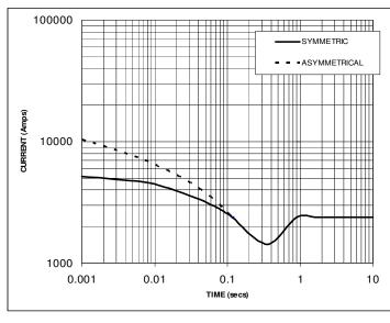
THE FOLLOWING MULTIPLICATION FACTORS SHOULD BE USED TO ADJUST THE VALUES FROM CURVES BETWEEN THE 0.001 SECONDS AND THE MINIMUM CURRENT POINT IN RESPECT OF NOMINAL OPERATING VOLTAGE
