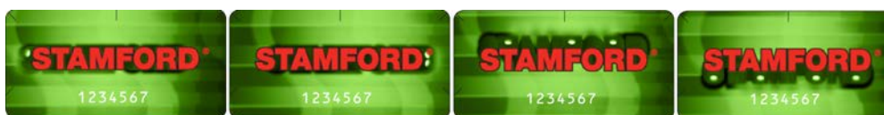
FIGURA 3. PONTOS VISÍVEIS NAS VISTAS ESQUERDA, DIREITA, SUPERIOR E INFERIOR DO HOLOGRAMA 3D
