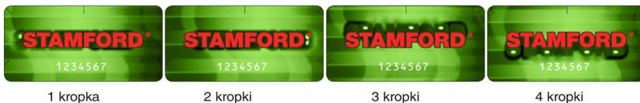
RYSUNEK 3. KROPKI WIDOCZNE W CZASIE OGLĄDANIA TRÓJWYMIAROWEGO HOLOGRAMU POD RÓŻNYMI KĄTAMI.
