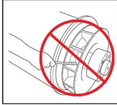
الشكل 28. لا تقم بتدوير العضو الدوار لمولد التيار المتردد بواسطة رافعة
